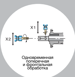
Внутренняя обработка при синхронизации движения по осям
