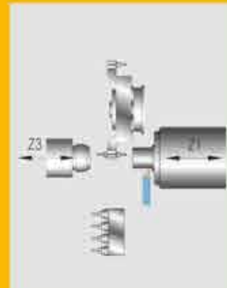
Одновременное сверление передней и противоположной стороны (Z1,Z3)
